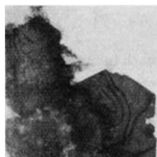
Fig. 5. Hydroxychromat III \beta und III \alpha (60% Lauge, 4½ Monate alt). Vergr. 3500fach.
